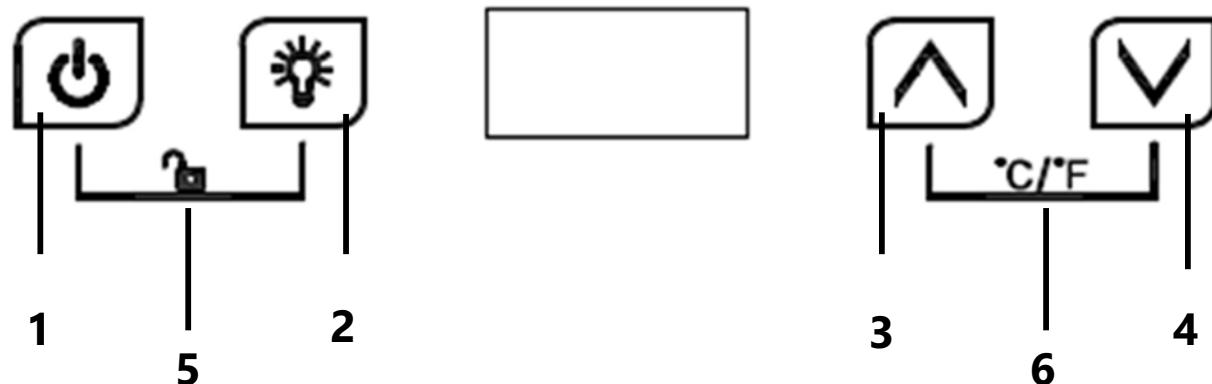
Обратите внимание, что при подключенном питании, панель управления прибора по умолчанию заблокирована. Для разблокировки нажмите одновременно на кнопки «Включение/Выключение» и «Подсветка» и удерживайте нажатыми в течение 3 секунд.
