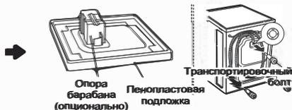
Снимите транспортировочные болты и опоры.
