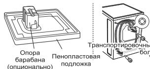
Снимите транспортировочные болты и опоры.
