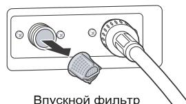
Очистите фильтр клапана впуска воды или переустановите шланги подачи воды.
