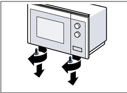
5. Fixați cadrul de montare la baza cuptorului cu microunde cu cele două șuruburi exterioare.
