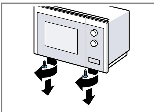
5. Rögzítse a mikrohullámú sütő alján a beépítő kereket a két külső csavarral.
