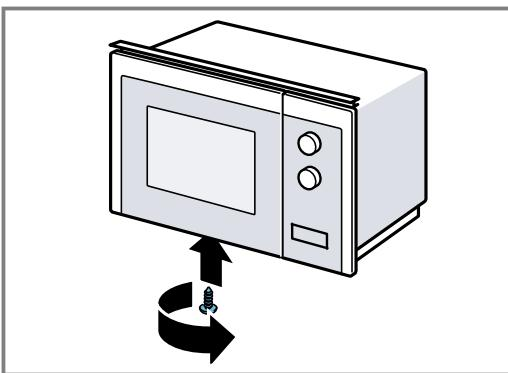
4. Desfiletați cele 2 șuruburi exterioare ale bazei cuptorului cu microunde.
