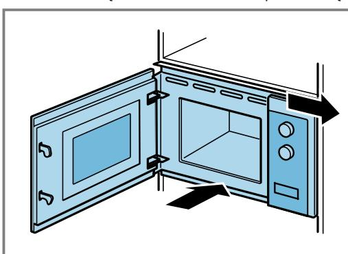
**3. Dokręcać urządzenie, aż zostanie wyśrodkowane.**
