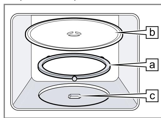
2. Вставьте вращающуюся подставку **b** в приводной механизм **c** посередине дна рабочей камеры.
