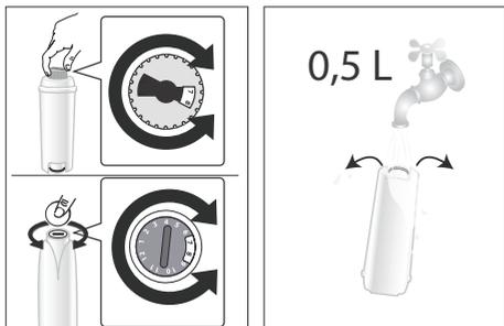
2. Чтобы активировать фильтр, необходимо залить водопроводную воду в отверстие фильтра, чтобы вода выходила из боковых отверстий в течение более одной минуты.
