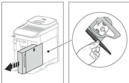
4. Нажмите внутрь две цветные кнопки отсоединения и одновременно потяните заварочный узел наружу.
