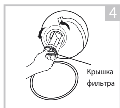
Откройте крышку фильтра, повернув против часовой стрелки
