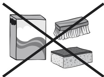
При чистке керамики необходимо соблюдать те же принципы, что и при чистке стеклянных поверхностей. Ни в коем случае не применять химических (агрессивных в реакции) чистящих средств, песка для чистки или губки с царапающей поверхностью. Нельзя также применять аппараты для чистки паром.
