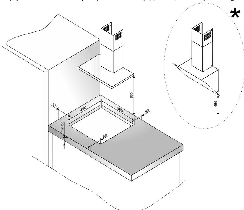
\* Минимальное расстояние вытяжки от столешницы в случае прямой вытяжки должно быть 650мм, а в случае наклонных вытяжек 450мм
