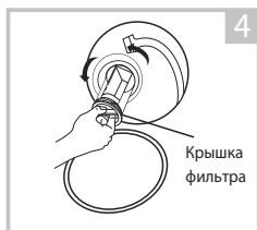
Откройте крышку фильтра, повернув против часовой стрелки
