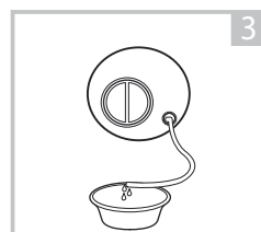
Когда вода стечет, уберите шланг аварийного слива
