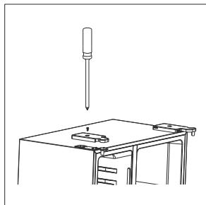
1. Отвинтите крышку петли при помощи крестовой отвертки.
