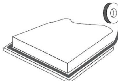
4. Не используйте клей при установке панели в столешницу! После наклейки уплотнителя вставьте панель в подготовленный вырез, слегка надавите на неё, чтобы она стала на место, обеспечив плотное прилегание внешнего края к столешнице.
