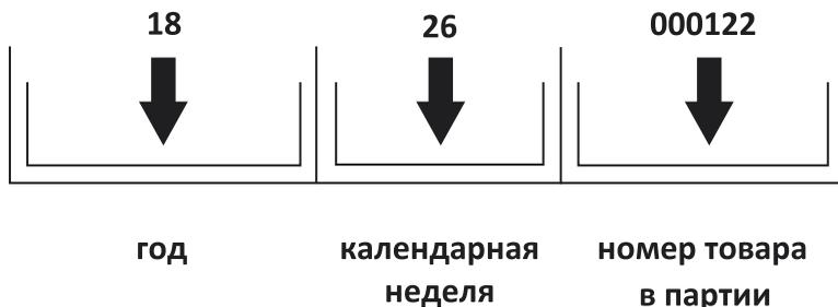
В данном примере прибор изготовлен на 26 неделе 2018 года.
