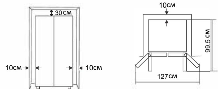
Пол помещения установки должен быть ровным, прочным и сухим. Если пол неровный, установите и закрепите регулируемые ножки, чтобы избежать вибрации и шума.
