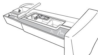
**8** Плотно закройте крышки отсеков **ezDispense**.
