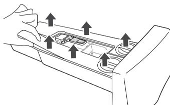
**7** Промойте внутренние части отсеков теплой водой.
