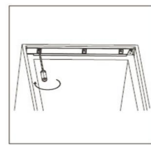
7. Установите четыре направляющих с ползунками и закрепите их короткими винтами. Затем закрепите накладки направляющих.
