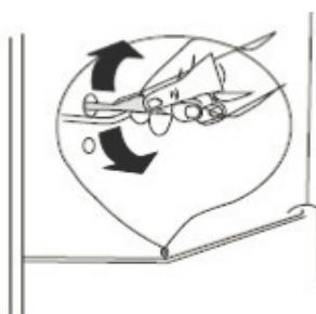
Чтобы избежать попадания талой воды внутрь холодильника, периодически очищайте дренажное отверстие в задней части холодильника. Используйте очиститель для очистки отверстия, как показано на картинке.
