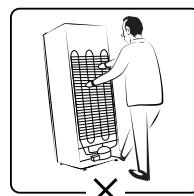
**Категорически запрещается перемещать холодильник, держась за конденсатор, расположенный на задней стенке шкафа. Это является нарушением правил эксплуатации и может привести к выходу из строя холодильника.**
