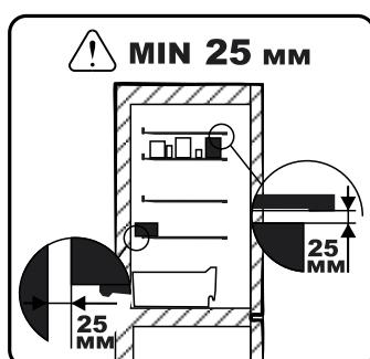
Для эффективного функционирования холодильника обеспечьте свободную циркуляцию воздуха внутри холодильной камеры, укладывая продукты и напитки так, чтобы по всей высоте холодильной камеры оставался зазор не менее 25 мм между продуктами на полках и задней стенкой шкафа, между продуктами и выше расположенными полками.
