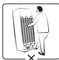
**Категорически запрещается перемещать холодильник, держась за конденсатор, расположенный на задней стенке шкафа. Это является нарушением правил эксплуатации и может привести к выходу из строя холодильника.**
