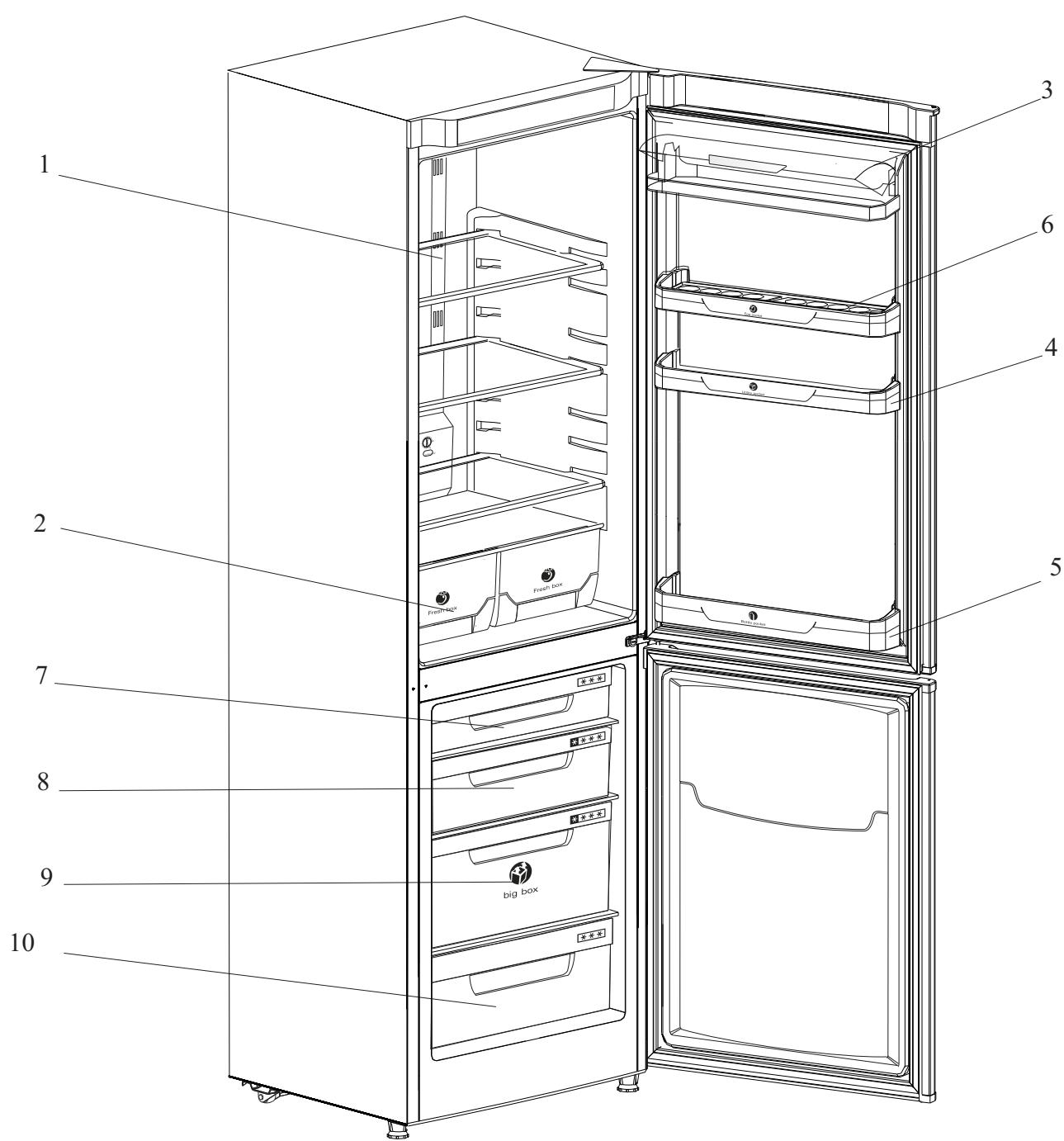
Рис. 1 Схема расположения отделений холодильника и его комплектующих.
