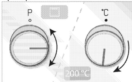
1. Выберите рабочую функцию для готовки с помощью ручки выбора функции.
