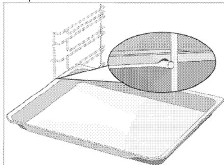
**Mise en place appropriée de la grille métallique et du plateau sur les rails télescopiques**
