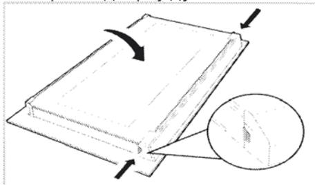
2. Потяните пластиковый компонент, прикрепленный в верхней части передней двери, к себе, одновременно надавив на точки давления с обеих сторон компонента, и снимите его.
