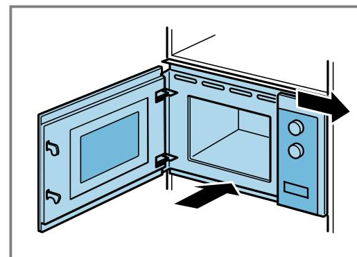
3. Dokręcać urządzenie, aż zostanie wyśrodkowane.
