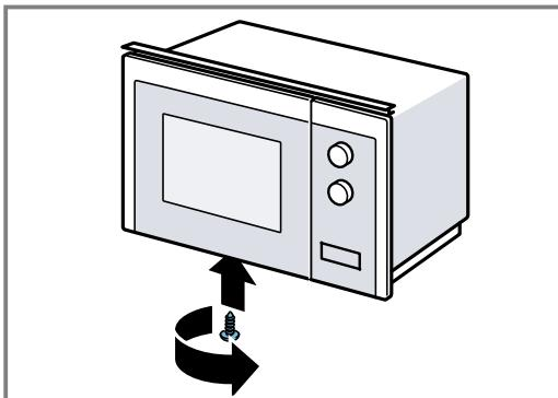
4. Desfileați cele 2 șuruburi exterioare ale bazei cuptorului cu microunde.
