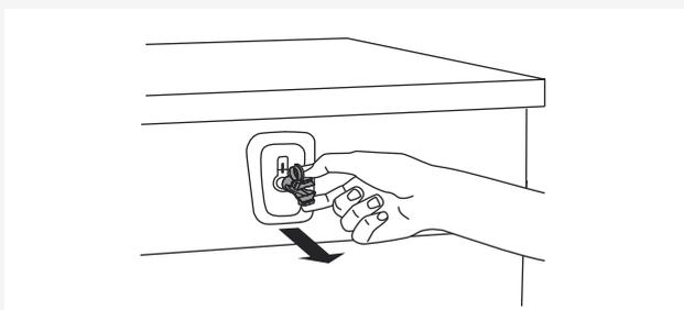
**2** Чтобы снять пластиковые втулки, крепящие винты, нажмите на втулку по бокам и извлеките.
