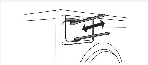
**3** Очистите щеткой отсек дозатора, особенно форсунки в верхней части отсека.
