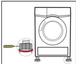
После того как прибор будет установлен в место предполагаемого использования, отрегулируйте его по уровню с помощью инструмента, затем зафиксируйте положение. Сушильную машину следует устанавливать на твердой и ровной поверхности.
