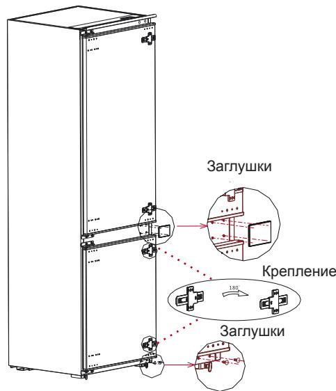
9. Поверните два крепления мебельного фасада на 180 градусов и установите их с противоположной стороны. Установите в освободившиеся посадочные места 2 нижние и 1 верхнюю заглушку соответственно. Убедитесь в том, что двери закрываются правильно и плотно прижимаются к каркасу холодильника.
