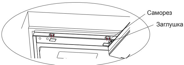
4. Прикрепите верхний козырек к шкафу при помощи саморезов, затем закройте их заглушками. Проверьте правильность закрывания верхних и нижних дверных панелей.
