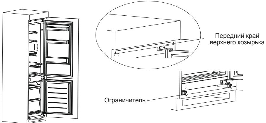
2. Вставьте холодильник в нишу не полностью. Выдвиньте до конца ограничители из опор холодильника и поверните их длинной стороной вниз, затем задвиньте холодильник в нишу так, чтобы они сцепились с передним краем нижней полки шкафа, тем самым зафиксировав глубину установки прибора. Передний край верхнего козырька должен при этом наложитьться на нижний край шкафа.
