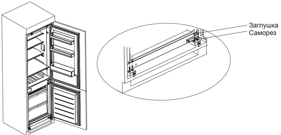
3. Прикрепите опорные ножки к шкафу при помощи саморезов. Закройте саморезы заглушками. Задвиньте нижние ограничители устранив сцепление с полкой шкафа.
