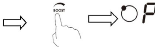
4. Конфорка будет работать в режиме усиленной мощности 5 минут, после чего функция PowerBoost отключится, и конфорка продолжит работу на той мощности, которая была установлена до включения функции PowerBoost.
