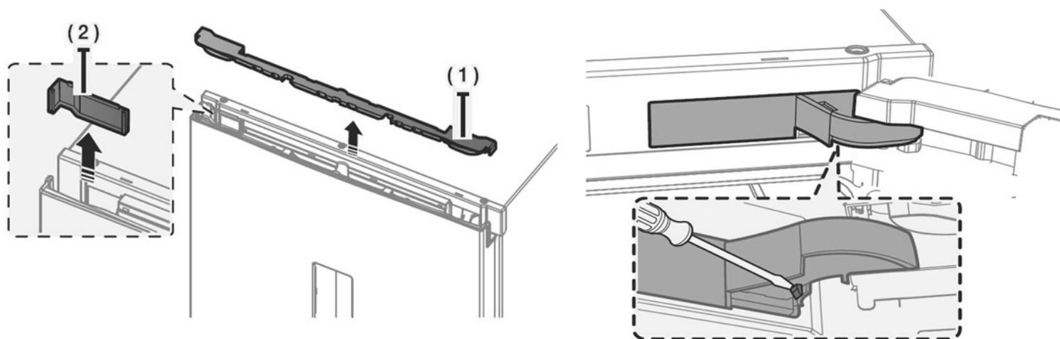
3. Отсоедините провода, подключающие дисплей на дверце прибора.
