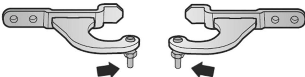
14. Установите верхнюю петлю на корпус прибора. Установите верхнюю дверцу прибора на петли. Прикрутите петлю винтами к корпусу.
