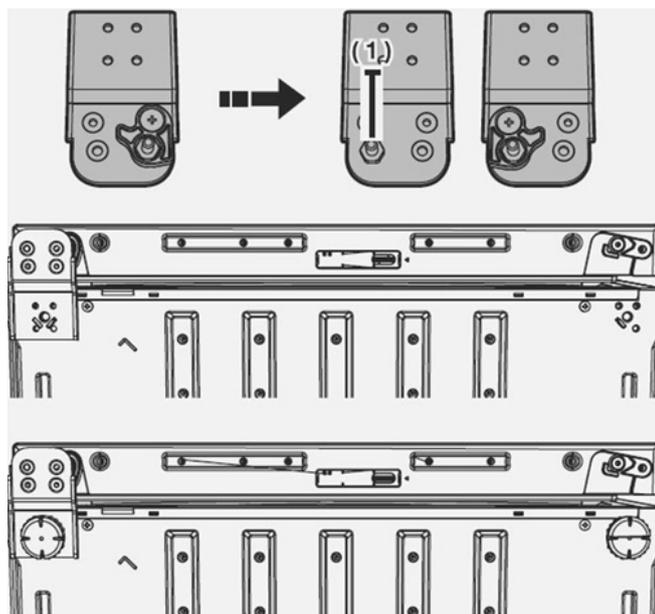
12. Снимите защитную накладку с отверстия на лицевой стороне в верхней части корпуса прибора (1) (где не было дверной петли). Поменяйте расположение проводов для подключения верхней дверцы на противоположную сторону (2). Закройте снятой защитной накладкой первое отверстие (3) (где ранее была петля).
