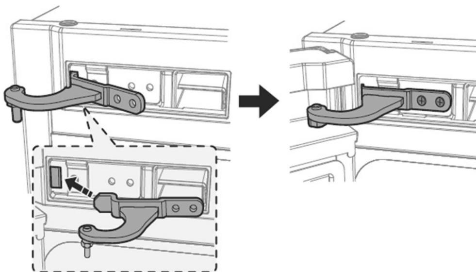
15. Подсоедините провода дверцы прибора. Установите защитную накладку на петли, предварительно разместив в ней провод и закрепив его как показано на рисунке.
