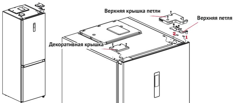
3. Снимите дверь холодильной камеры, немного приподняв её. Демонтируйте среднюю петлю, используя ключ и крестовую отвертку. Снимите две декоративные пластиковые заглушки на противоположной стороне, используя шлицевую отвёртку.
