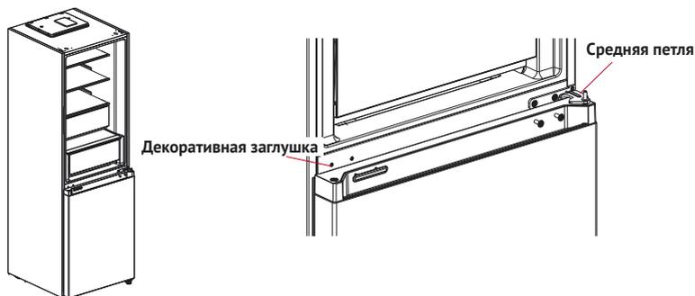
4. Снимите дверь морозильной камеры, немного приподняв её. Демонтируйте нижнюю петлю, используя ключ и крестовую отвёртку. Отрегулируйте уровень на ножках, как показано на рисунке ниже. Перекиньте штырёк петли на противоположную сторону петли. Снимите две декоративные пластиковые заглушки на противоположной стороне, используя шлицевую отвёртку. Установите петлю на противоположную сторону. Установите декоративные заглушки в освободившиеся отверстия на правой стороне.
