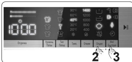
Если при активированной блокировке от детей нажата какая-либо кнопка или выбранная программа изменена с помощью диска выбора программ, на электронном дисплее в течение 2 секунд будет мигать сигнал «CL».
