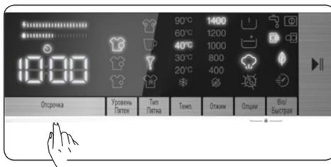
Эту дополнительную функцию можно использовать, чтобы отложить запуск цикла стирки на период от 1 до 23 часов. Чтобы использовать функцию отложенного запуска:
