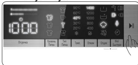
Нажатием кнопки Пуск/Пауза вы можете запустить выбранную программу или приостановить выполняемую программу. При переключении машины в режим ожидания, на электронном дисплее начнет мигать индикатор «Пуск/Пауза».
