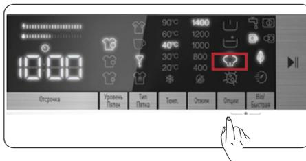
Благодаря паровой системе глажка стала быстрой и легкой. Пар, , используемый для стирки, проникает и
