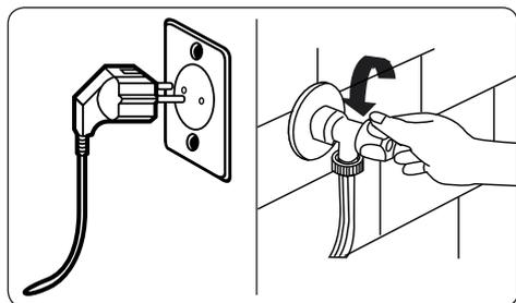
Прежде чем приступить к техническому обслуживанию и чистке машины, отключите электропитание и выньте вилку из розетки. Прежде чем приступить к техническому обслуживанию и чистке машины, закройте кран подачи воды.
