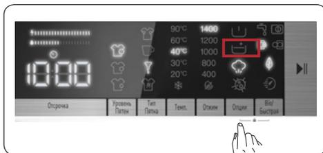
Эту дополнительную функцию можно использовать для дополнительного полоскания своего белья. Чтобы включить функцию дополнительного полоскания, продолжайте нажимать клавишу выбора до тех пор, пока не появится символ дополнительного полоскания . Если светодиодный индикатор дополнительного полоскания постоянно светится на электронном дисплее, это означает, что дополнительная функция выбрана.
