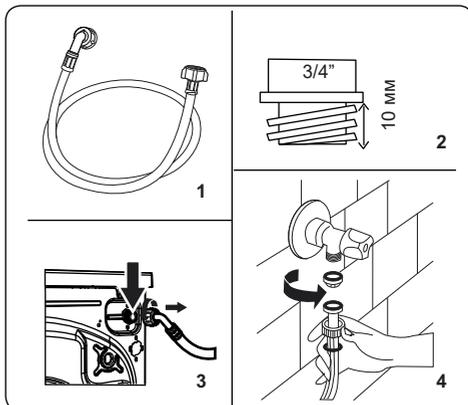
1. Ваша машина может иметь одно подключение к линии водопровода (с подводом холодной воды) или два подключения (с подводом холодной/горячей воды) в зависимости от спецификации машины. Шланг с белым наконечником предназначен для подключения к линии холодного водоснабжения, с красным – горячего (если применимо).
