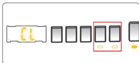
Если при активированной блокировке от детей нажата какая-либо кнопка или выбранная программа изменена с помощью диска выбора программ, на электронном дисплее в течение 2 секунд будет мигать сигнал «CL».
