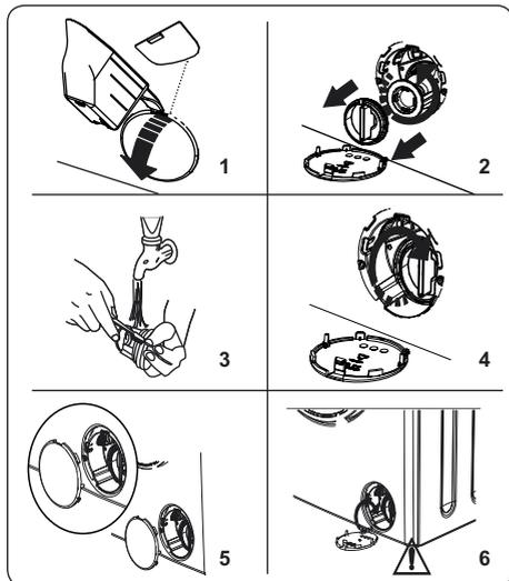
Фильтровальная система насоса машины продлевает срок службы насоса, предотвращая попадание ворсинок в машину. Мы рекомендуем очищать фильтр насоса раз в 2 месяца.
