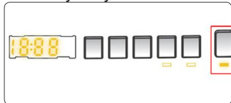
Нажатием кнопки «Пуск/Пауза» вы можете запустить выбранную программу или приостановить выполняемую программу. При переключении машины в режим ожидания, на электронном дисплее начнет мигать индикатор «Пуск/Пауза».
