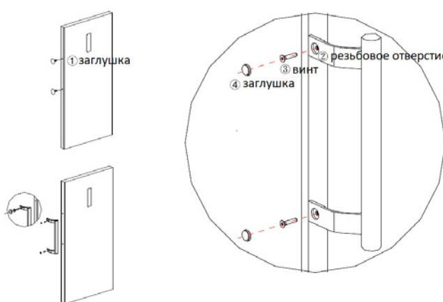
Снимите заглушки (1), закрывающие отверстия для винтов.
