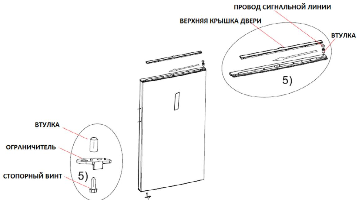
6 Достаньте левый шарнир из пакета и крышку шарнира. Установите дверь на левый нижний шарнир и установите левый верхний шарнир. Соедините разъемы 1 и 5. Соедините разъем сигнальной линии 6 с дверным выключателем. Соедините разъемы 2 и 4 сигнальной линии. Установите крышку петли и крышку отверстия.
