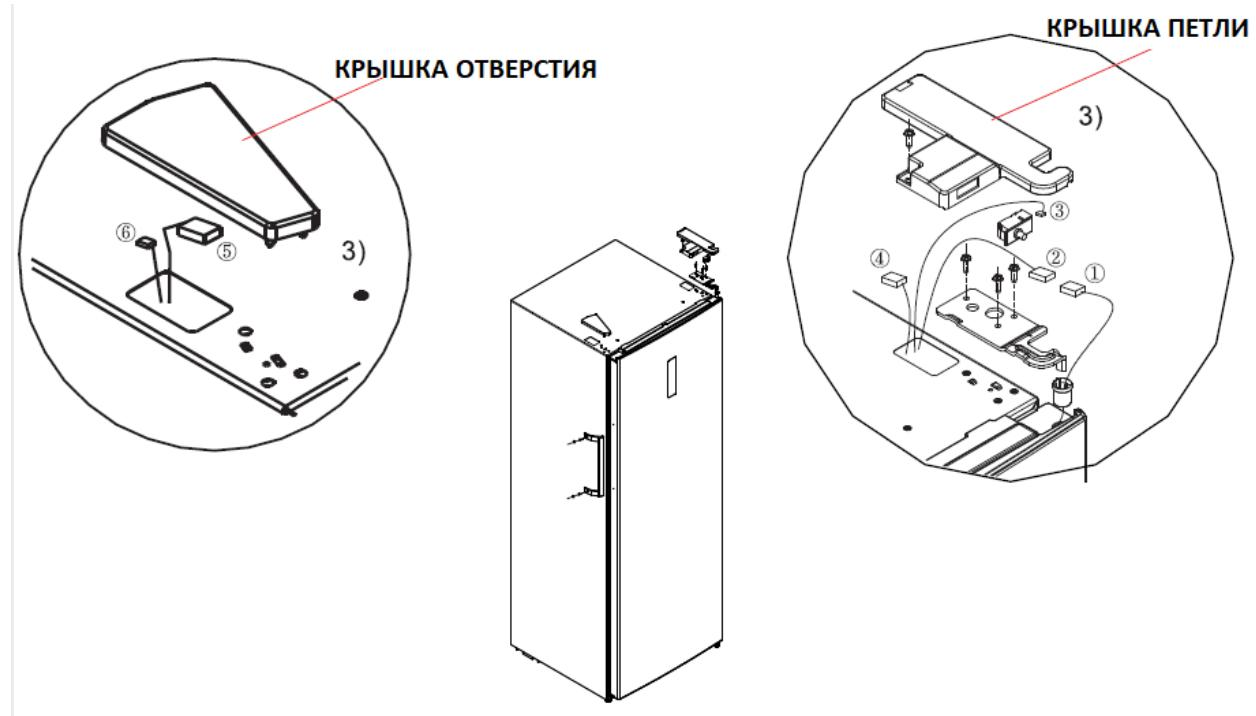
4 Снимите дверь и правую сборку петли (петля, ось, регулируемые ножки). Перенесите (смонтируйте) на левую сторону. Справа смонтируйте регулируемую ножку.
