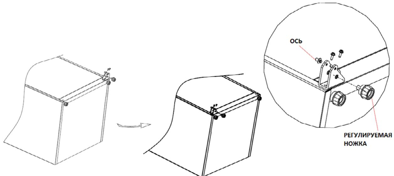
5 Снимите верхнюю крышку двери. Установите верхнюю втулку. Сигнальный провод двери переведите на левую сторону и закройте верх крышкой двери. Снимите правый ограничитель двери, достаньте втулку из нижней правой части двери, достаньте левый ограничитель из пакета с принадлежностями и установите его на левую сторону двери. Правый ограничитель советуем сохранить. Возможно пригодится в будущем.
