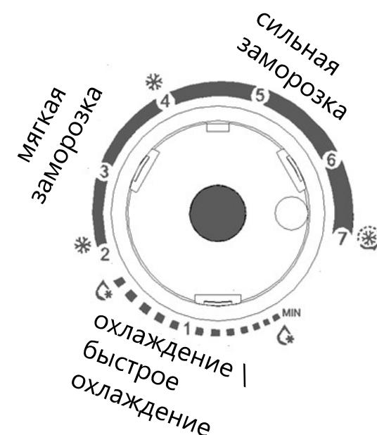
Температура морозильной камеры регулируется с помощью ручки, установленной на термостате. Цифры указанные на термостате «1, 2, 3, 4, 5, 6, 7» не обозначают конкретную температуру. Чем меньше цифра, тем выше температура:
