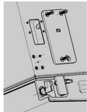
5. Поднимите дверцу вверх на 50 мм, чтобы снять дверцу прибора.
