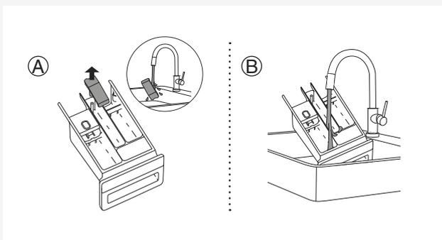
**2** Тщательно очистите и промойте дозатор под проточной водой. Можно снять колпачок дозатора в отделении для кондиционера (А). Промойте и очистите колпачок и внутренние поверхности дозатора от загрязнений.
