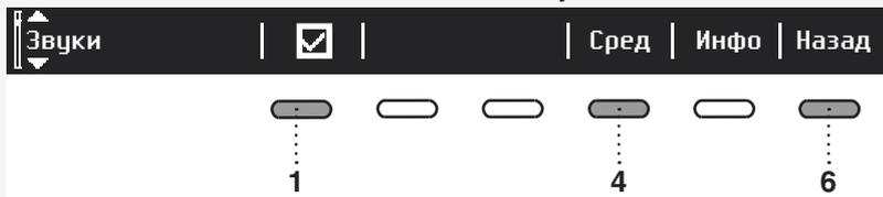
Кнопкой 1 выберите, включить  или выключить  звуковой сигнал. Кнопкой 4 выберите громкость сигнала: низкий (Low), средний (Mid) и высокий (High). При настройке вы слышите выбранный уровень громкости.
