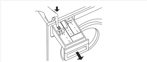
**1** Нажмите на язычок и полностью извлеките дозатор из отсека.
