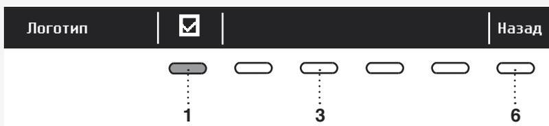
Кнопкой 1 выберите, включить  или выключить  вывод Логотипа (Logotype). Выбор  означает, что при включении машины на дисплее высвечивается логотип.
