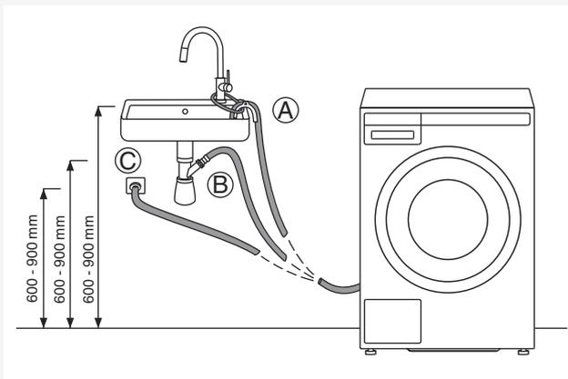
Сливной шланг можно подсоединить непосредственно к сливу раковины с помощью сифона. Шланг также должен находиться на высоте 600-900 миллиметров над уровнем пола. Внутренний диаметр отверстия должен составлять не менее 18 миллиметров. См. рисунок.
