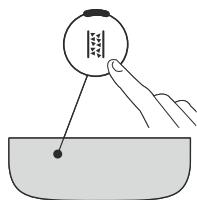
Нажмите на одно из зерен, чтобы установить или заменить установленный фильтр для смягчения воды
