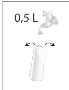
2. Чтобы активировать фильтр, необходимо залить водопроводную воду в отверстие фильтра, чтобы вода выходила из боковых отверстий в течение более одной минуты.
