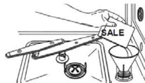
Для обеспечения исправной работы умягчителя воды прибор регулярно выполняет цикл регенерации.
