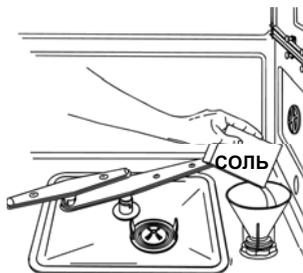
При средней жесткости воды обновляйте соль примерно после 20 **циклов мойки**. Емкость умягчителя рассчитана примерно на **1 кг** соли в гранулах. Некоторые модели оснащены оптическим индикатором отсутствия соли. На крышке емкости для соли у этих моделей расположен зеленый поплавок, который опускается по мере уменьшения количества соли. Когда зеленый поплавок пропадает, это значит, что необходимо добавить соль. Емкость для соли расположена в низу посудомоечной машины.
