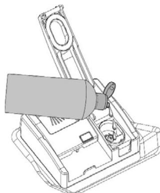
**НАСТРОЙКА ДОЗИРОВКИ ОПОЛАСКИВАТЕЛЯ**
