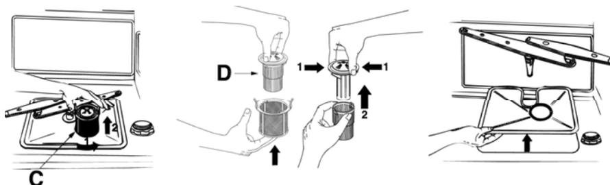
**ОЧИСТКА ФИЛЬТРУЮЩЕГО УЗЛА (модели с планетарным распылителем)**
