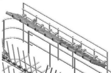
**держатель для стаканов. (glass holder).** Подставка для бокалов на длинной ножке. Поднимая ее, она поворачивается из исходного положения (0) и защелкивается в трех разных положениях (1-2-3).
