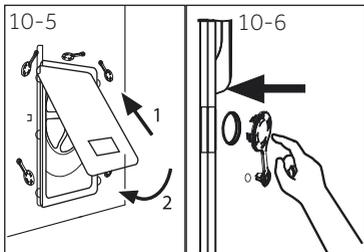
3. Заново установите заднюю крышку, вставив ее в два отверстия, обращенных выступающей частью наружу (рис. 10-5).
