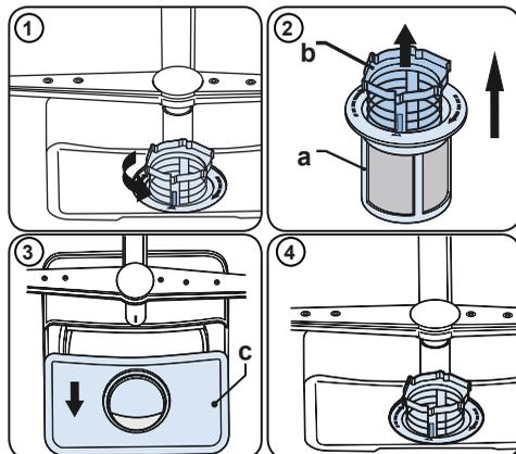
Чтобы снять и очистить блок фильтров, поверните его против часовой стрелки и извлеките, потянув вверх (1). Вытащите фильтр грубой очистки из микрофильтра (2). Затем извлеките металлический фильтр (3). Промойте фильтры большим количеством воды, чтобы на них не осталось посторонних веществ. Снова соберите фильтры. Установите на место фильтрующий элемент и поверните его по часовой стрелке (4).
