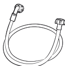
Шланг подачи холодной воды
