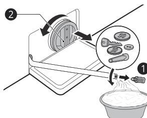
**1** После очистки фильтра сливного насоса выньте его и вставьте сливную пробку.
