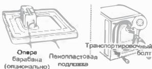
Снимите транспортировочные болты и опоры.
