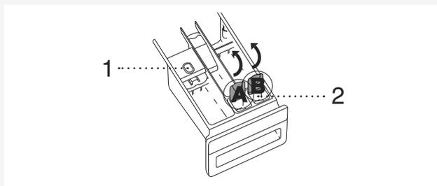
**1** Нажмите на язычок и полностью извлеките дозатор из отсека (1).
