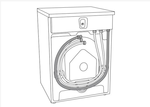
Машина поставляется с подсоединенным сливным шлангом, который необходимо подсоединить к стоку. Машину также можно подключить к встроенному в стену стоку с сифоном, который имеет возможность беспрепятственной очистки. Шланг должен находиться на высоте 600-900 миллиметров над уровнем пола. Более низкое положение (600 миллиметров) предпочтительнее. Обеспечьте отсутствие перегибов на сливном шланге.
