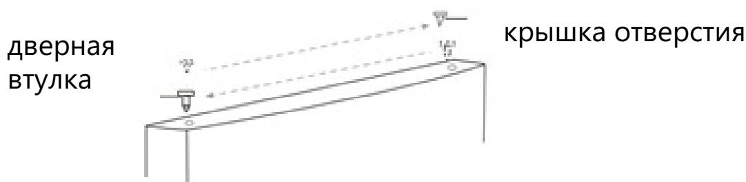
10. Удалите винт, который крепит крышку отверстия для винта шарнира в верхней левой части корпуса, снимите крышку и закрепите крышку в верхней правой части корпуса.
