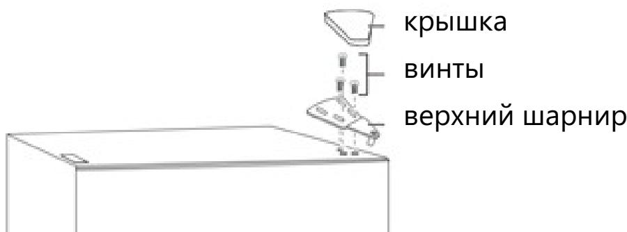
2. Снимите дверь морозильной камеры.
