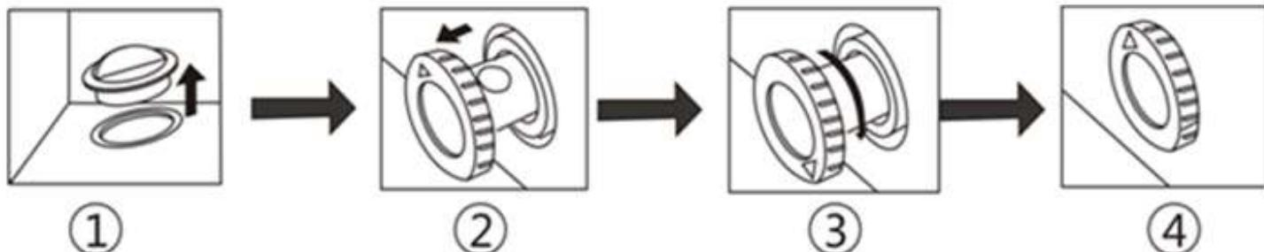
1. Сливное отверстие спроектировано в нижней части морозильного ларя. При размораживании снимите резиновую крышку.
