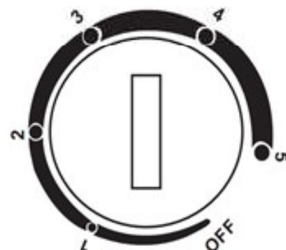
Температура морозильной камеры регулируется с помощью ручки, установленной на термостате. Цифры указанные на термостате «1, 2, 3, 4, 5» не обозначают конкретную температуру. Чем меньше цифра, тем выше температура:
