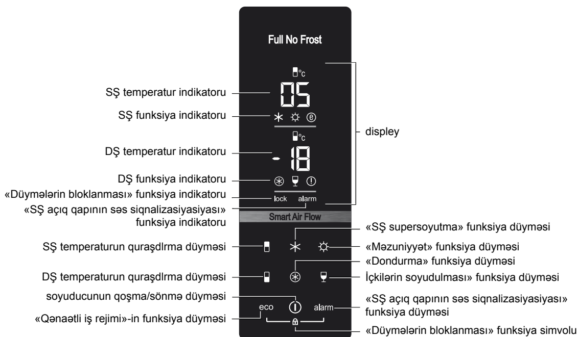
Səkil 3 – İdarəetmə bloku
