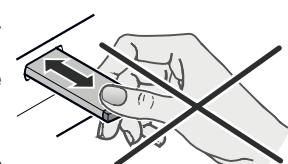
В исходном положении толкатель находится заподлицо с передней кромкой прибора.
