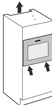
• Помещение для установки прибора должно в соответствии с нормой EN 378 иметь объем 1 м<sup>3</sup> на каждые 8 г хладагента типа R 600a, чтобы в случае утечки хладагента из контура в этом помещении не могла образоваться легковоспламеняемая газовоздушная смесь. Данные о количестве хладагента можно найти на заводской табличке, расположенной внутри прибора.
