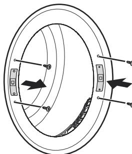
**7** Установите дверцу с извлеченными на шаге 1 винтами, а затем убедитесь, что дверца закрывается надлежащим образом.
