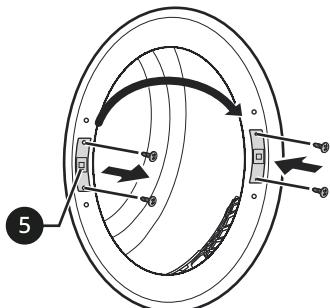
**6** Извлеките 2 декоративных винта из корпуса устройства, а затем установите их на противоположной стороне.
