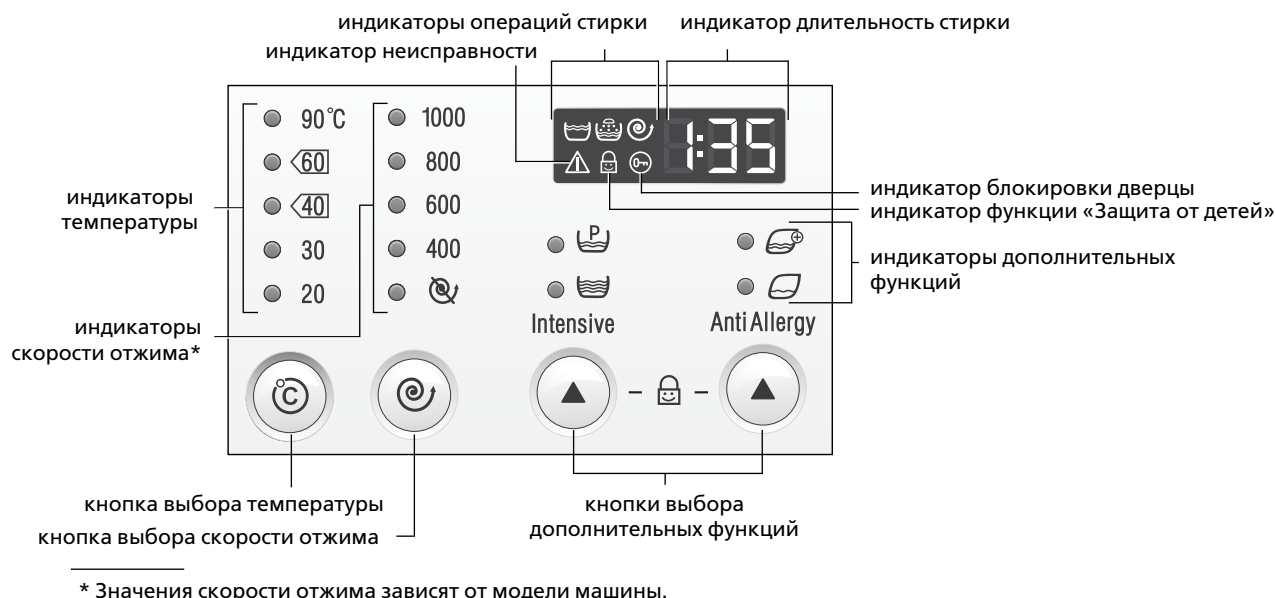
Рисунок 3 — Кнопки управления и зоны индикации
