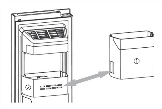
Если лёд не требуется, генератор льда можно отключить, и вместо контейнера для льда (1) установить дверные полки (2), чтобы обеспечить больше свободного места в морозильном отделении.
