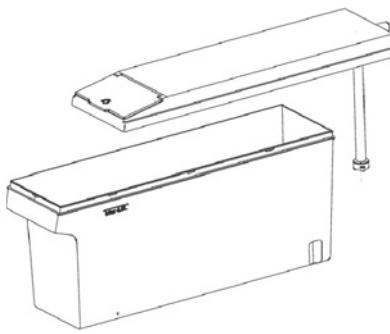
2. Снимите крышку резервуара для воды.
