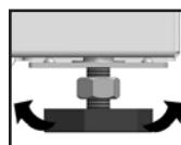
После того как прибор будет установлен на место предполагаемого использования, отрегулируйте его по уровню с помощью инструмента, затем зафиксируйте положение ножек с помощью контргайки. Стиральную машину следует устанавливать на твердой и ровной поверхности.
