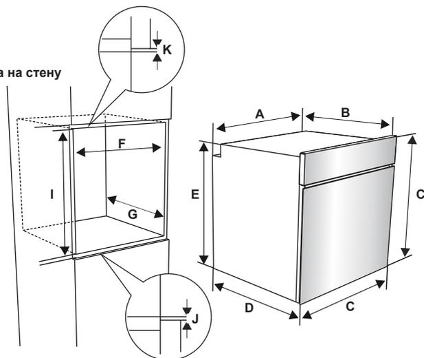
1. После подключения к электросети вставьте духовку в шкаф, продвигая ее от себя. Откройте дверь духовки и вставьте два винта в отверстия, расположенные на раме духовки. Убедившись, что рама продукта соприкасается с деревянной поверхностью шкафа, затяните винты.
