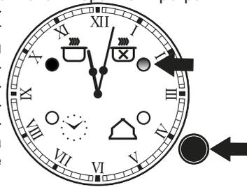
Когда установленное время окончания приготовления сравняется стекущим временем, световой индикатор рядом со знаком окончания времени приготовления «☒» начнет мигать, включится звуковой сигнал, освещение электрошкафа и сигнальная лампочка терморегулятора погаснут, автоматически отключится нагрев.
