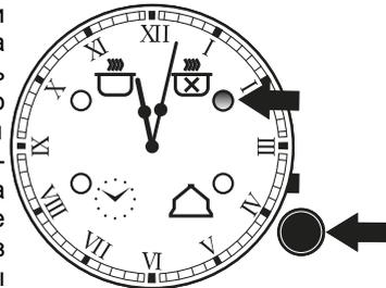
Для просмотра установленного времени после начала работы таймера необходимо один раз нажать на ручку программатора. Для отмены установленного таймера, необходимо нажать и удерживать несколько секунд ручку программатора до тех пор, пока индикатор таймера не погаснет.
